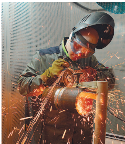
Участники конкурса заваривали стыки катушек стальной трубы
